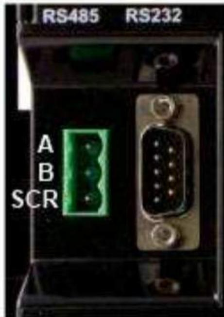
Figure 1.1 : DSE8620 RS485 connector
